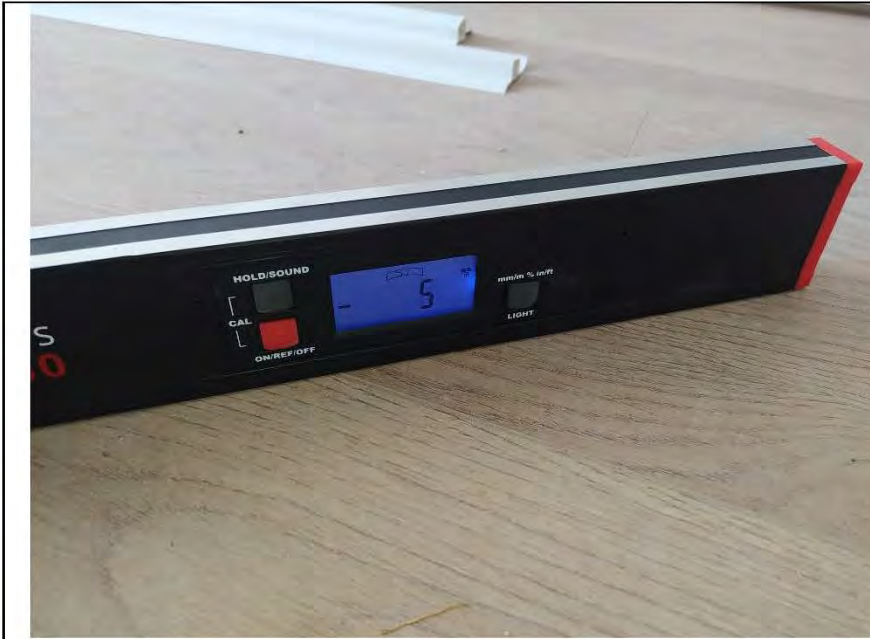
Фото №13. Измерения уровня напольного покрытия в спальне.
