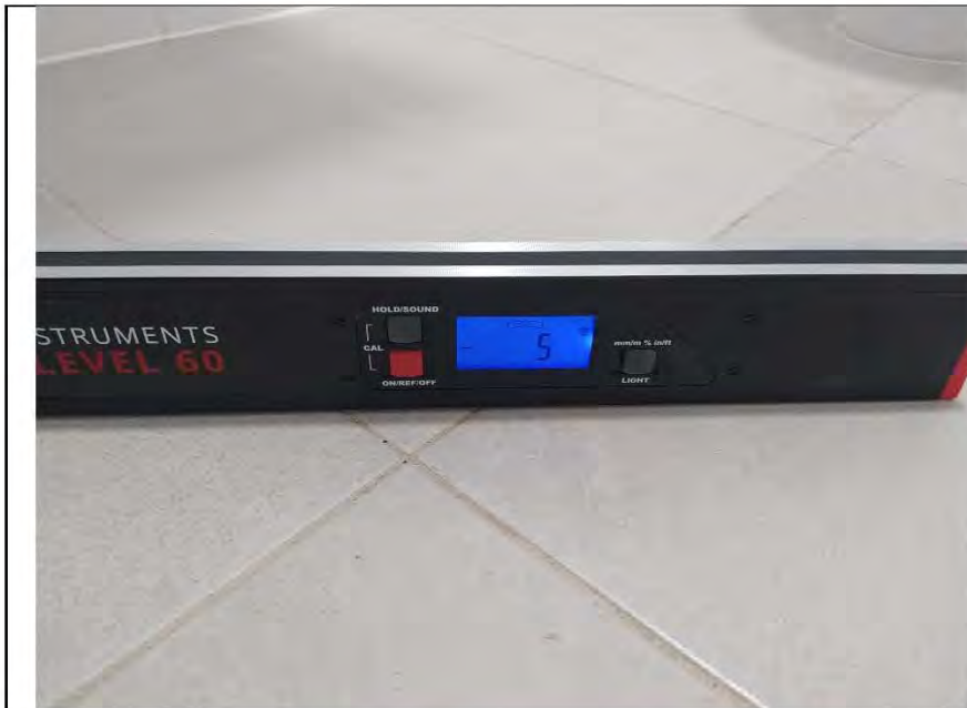
Фото №19. Измерения уровня напольного покрытия в санузле (керамическая плитка).
