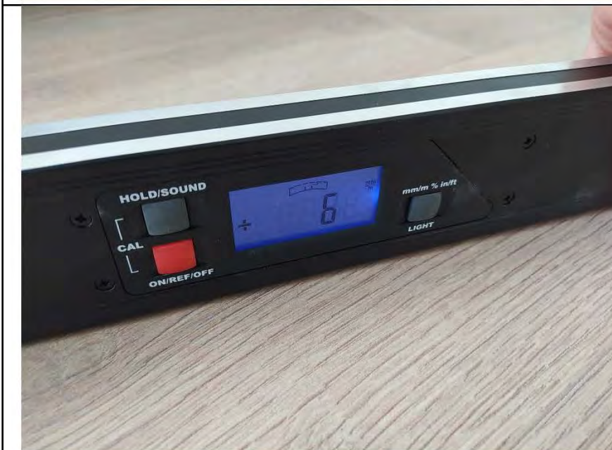
Фото №14. Измерения уровня напольного покрытия в гостиной.
