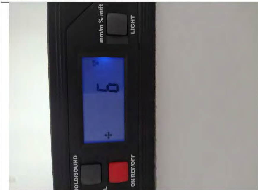
Фото №8. Измерения уровня стен в гостиной.
