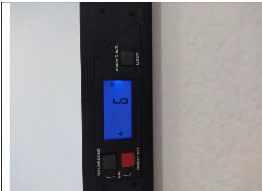
Фото №10. Измерения уровня стен в прихожей.
